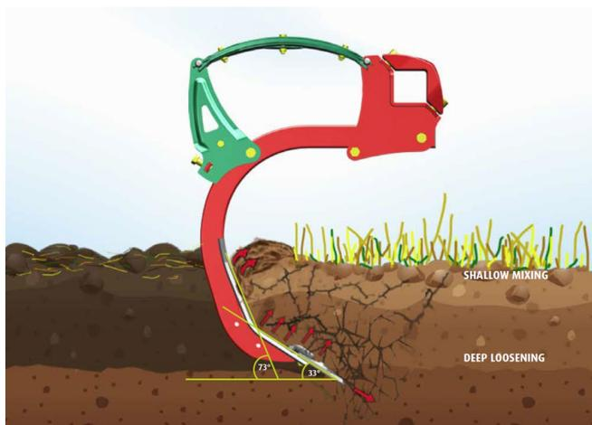
*Dente Triflex di Kverneland – due zone di lavoro ad angolazione diversa per eccellenti penetrazione e mescolamento di terreno e residui colturali.*
